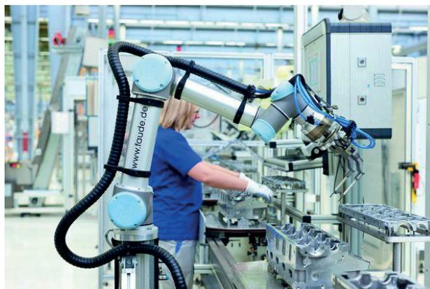
Le cobot, fabriqué par Universal Robots, a été intégré dans la section d'assemblage de culasses, où il est chargé de manipuler les bougies de préchauffage délicates à manier. Les employés de production qui étaient responsables du montage de ces bougies devaient adopter une position voûtée pour insérer eux-mêmes les bougies dans les trous de forage à peine visibles de la culasse.
