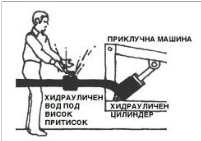
Сл. 202 Акумулирана енергија на хидрауличен систем
