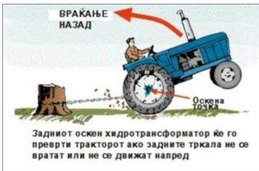
Сл. 127 Ако задните тркала не се вртат или движат напред тракторот се подига и превртува назад
