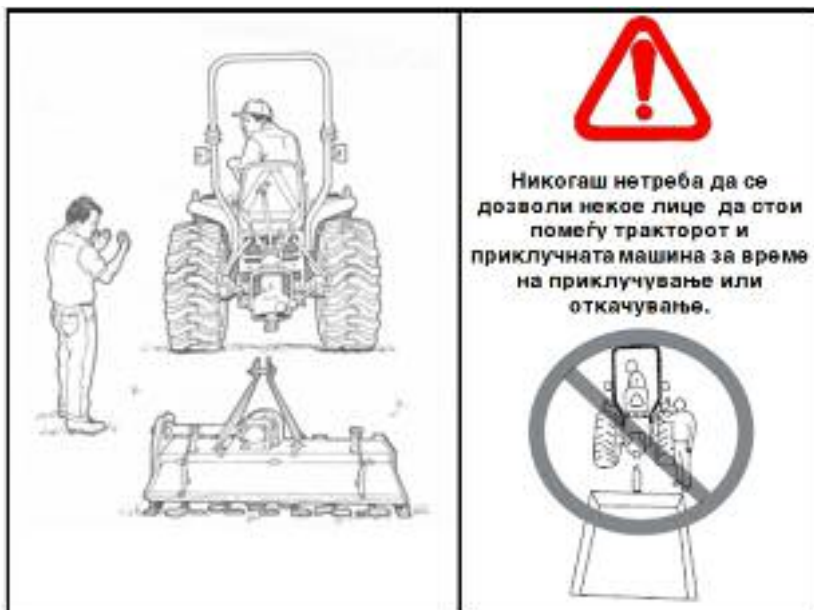
Сл. 131 Правилно приклучување на приклучната машина
