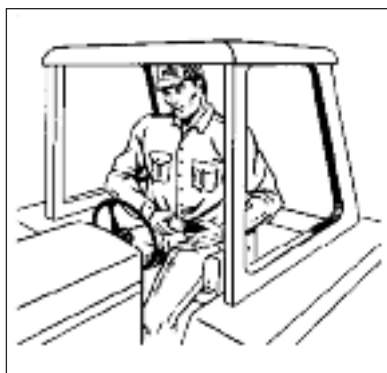
Сл. 153 Сигурносниот појас треба да се закопча доколку тракторот има вградена сигурносна рамка (Huitink G.)
