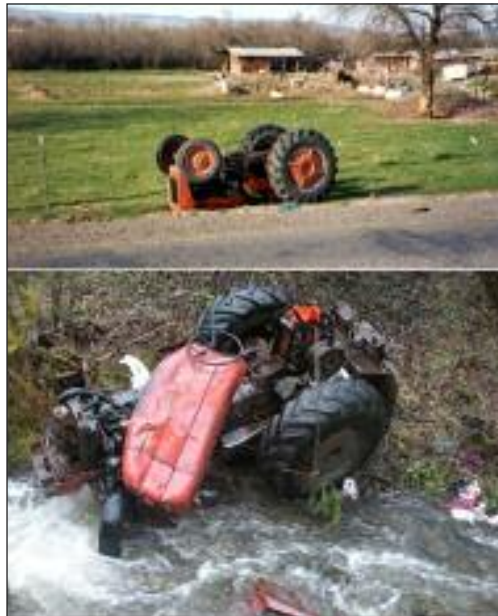
Сл. 119 Превртен трактор кој нема вградено заштитна рамка
