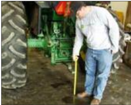
Сл. 19 Потегницата е проектирана на точна висина од подлогата, со цел да ги држи влечните сили под центарот на тежиштето на тракторот
