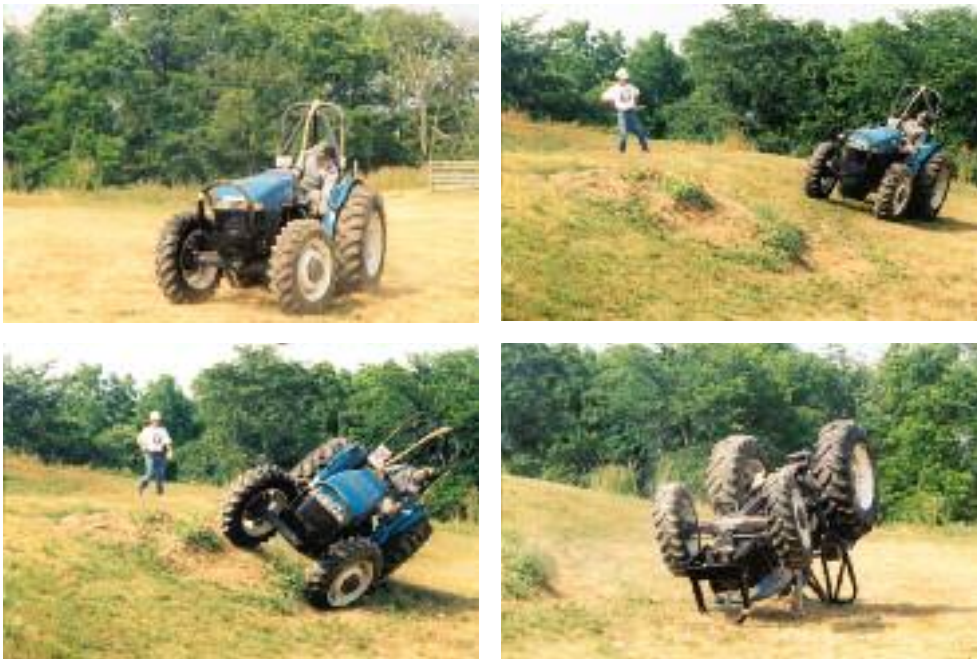
Сл. 97 Положба на стабилност и нестабилност на тракторот
