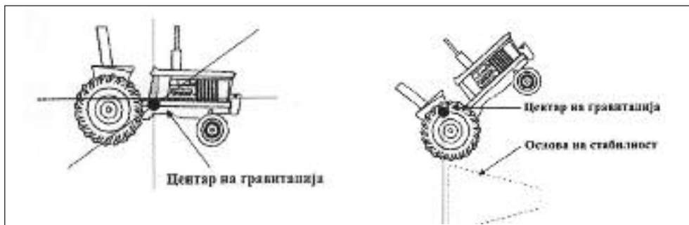
Сл. 113 Физика на стабилност на тракторот (Smith, 2004)
