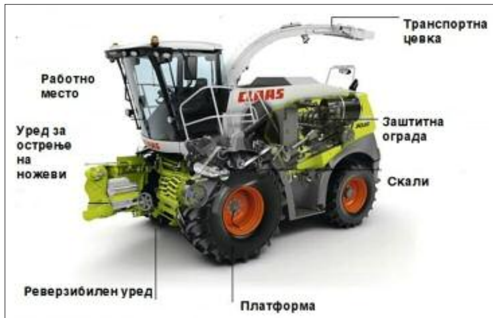
Сл. 220 Места на опасност кај силажен комбајн
