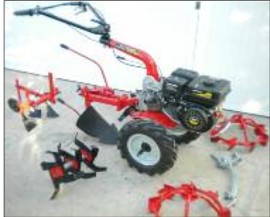
Сл. 6 Еднооскен трактор со додатни приклучоци
