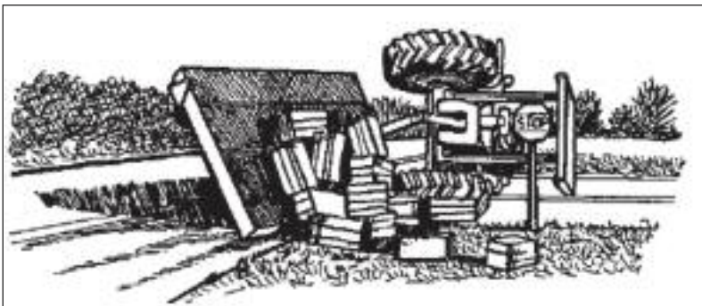
Сл. 159 Наглите свртувања или честите сопирања при големи брзини може да предизвика превртување или истурање на товарот (Huitink G.)
