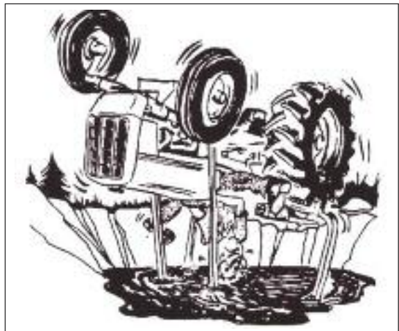
Сл. 85 Стабилноста на тракторот многу зависи од состојбата на пневматиците
