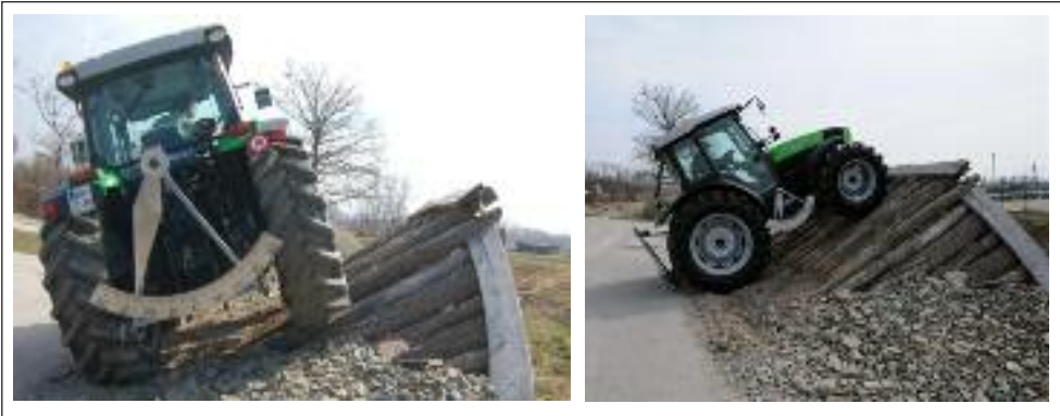
Сл. 103 Уред за мерење на наклонот на теренот за утврдување на стабилноста на тракторот
