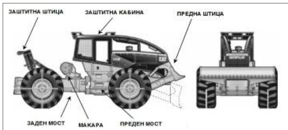
Сл. 232 Шумарски трактор - скидер Caterpillar 535 B
