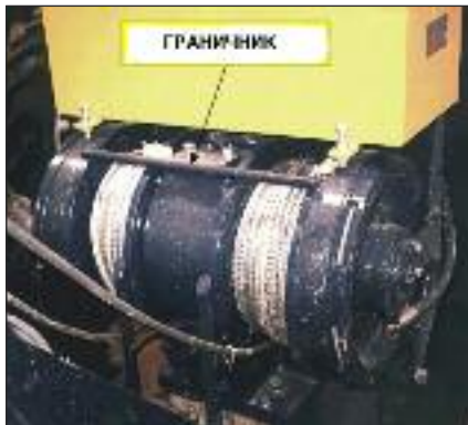
Сл. 230 Макара со два барабана и две челични јажиња
