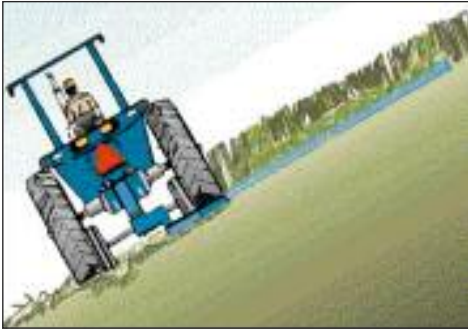
Сл. 156 Бочно агрегатираните приклучни машини треба да се насочат за време на работата кон наклонот на теренот (Huitink G.)
