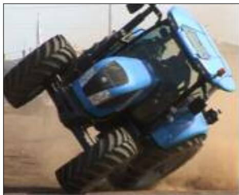
Сл. 110 Дејство на центрифугалната сила на тракторот
