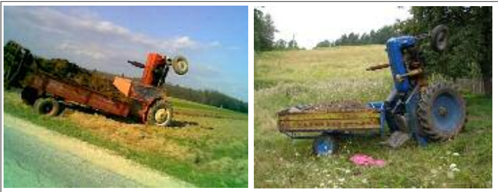
Сл. 128 Зголемената тежина на приколката го подигнува редниот дел на тракторот и го превртува
