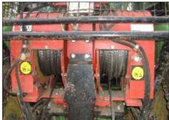
Сл. 230 Макара со два барабана и две челични јажиња
