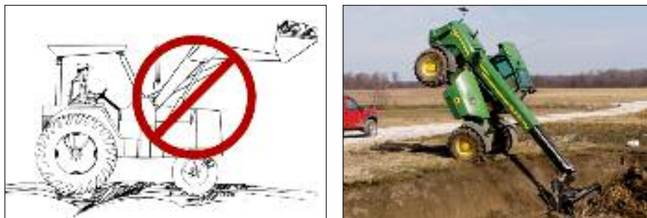
Сл. 142 Кога се управува тракторот со високо дигната корпа, без разлика дали е полна/празна, корпата треба да биде што пониско спуштена до земјата.
