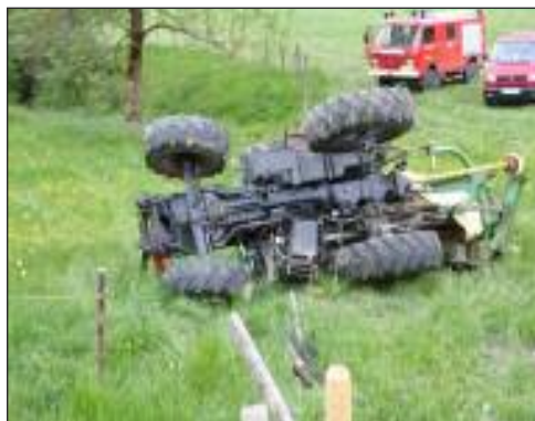
Сл. 110 Дејство на центрифугалната сила на тракторот
