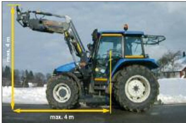
Сл. 55 Прописани мерки на тракторот и приклучните машини за движење во сообраќај (Gib Acht im Verkehr, 2011)
