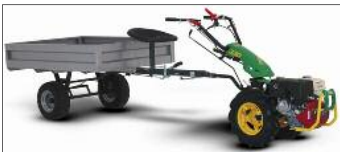
Сл. 5. Еднооскен трактор агрегатиран со приколка
