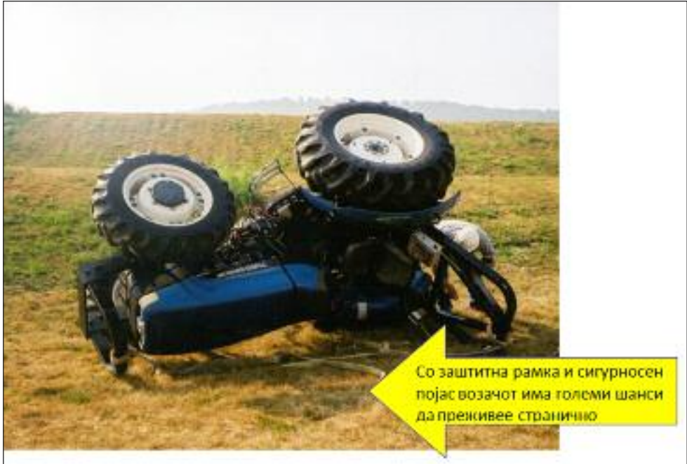
Сл. 122 Користење на заштитна рамка и сигурносен појас
