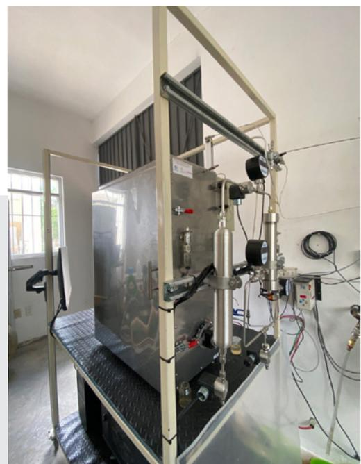
Sistema híbrido que produce hidrógeno verde en la Unidad de Energías Renovables del CICY.
