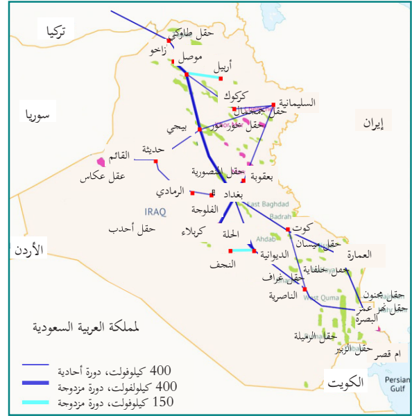
الشكل 7: شبكة العراق لنقل الكهرباء 42
