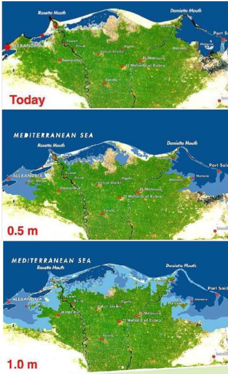
شكل ٢٥ المناطق المغمورة بالمياه حال ارتفاع منسوب سطح البحر نصف متر ومتر. المصدر: (Mehaina 2013)
