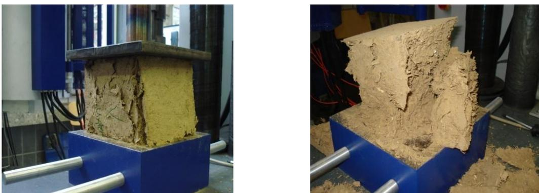
Bild 6.2: Druckversuch beim Lehmstein
