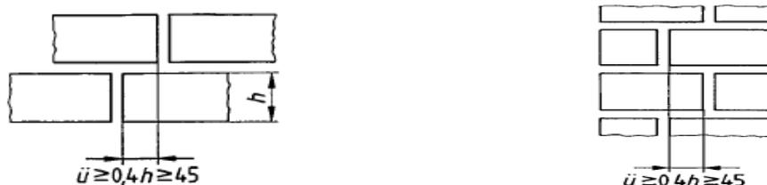
Abbildung 1.3: Überbindemaß beim Mauerwerk [3]
