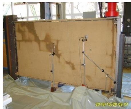
Bild 6.4: Vorbereitung, Verdichtung und Ausfachung vom Lehmstein
