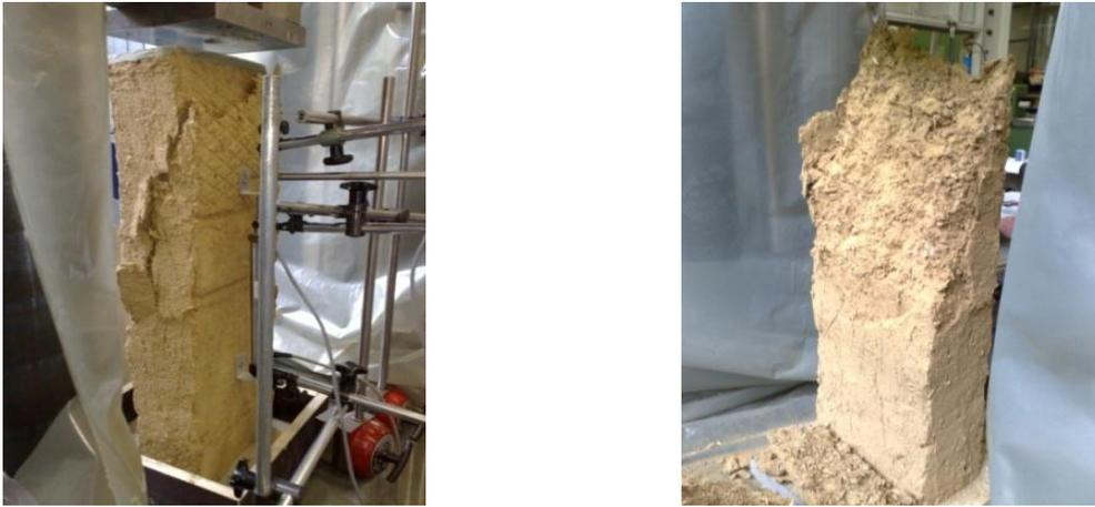
Bild 6.3: Druckversuch beim Lehmmauerwerk
