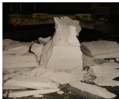
Bild 6.1: Druckversuche beim iranischen Ajor und deutschen Kalksandstein
