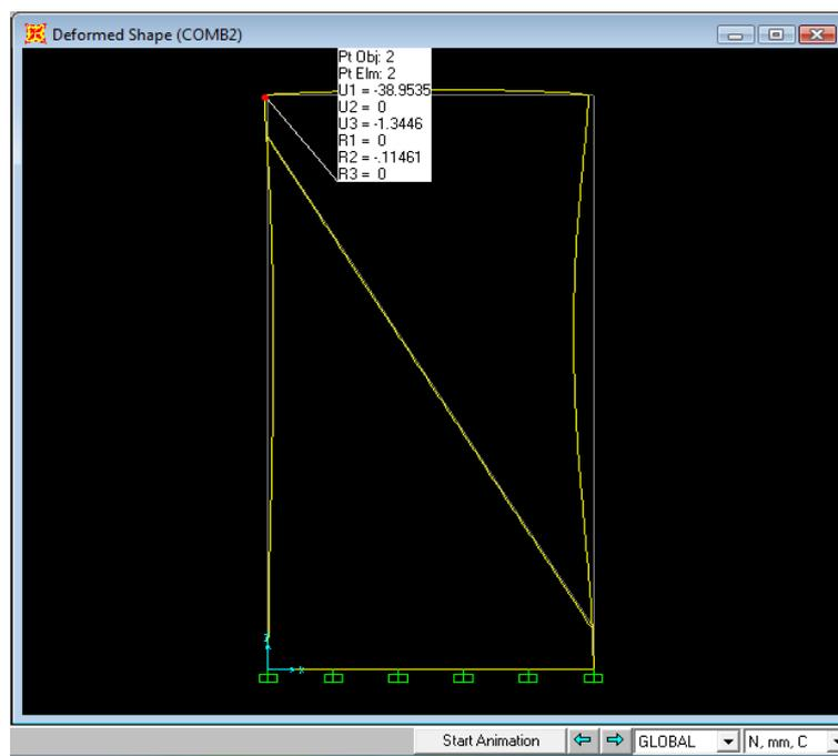
Abbildung 5.5: Kopfverschiebung beim Stahlrahmen ohne Ausfachtung
