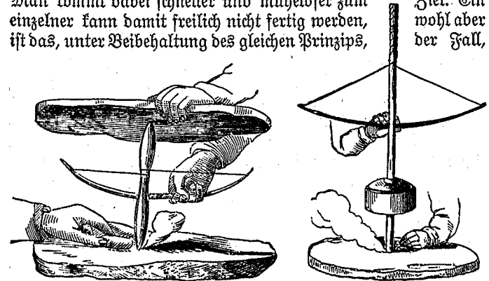
Figur 2. Feuerbohrer der Eskimos.
