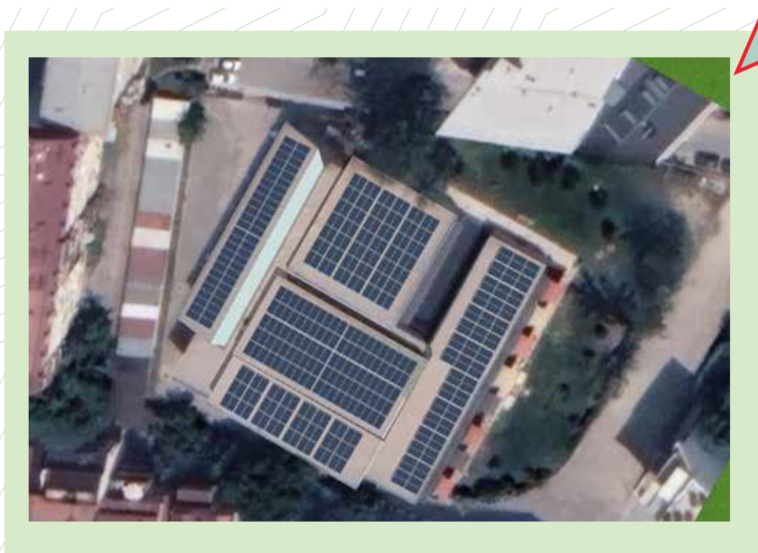
Слика 13. Визуелен приказ на предвидениот фотоволтаичен систем на кровните површини на ДГ „Кочо Рацин“ - Матичен објект
