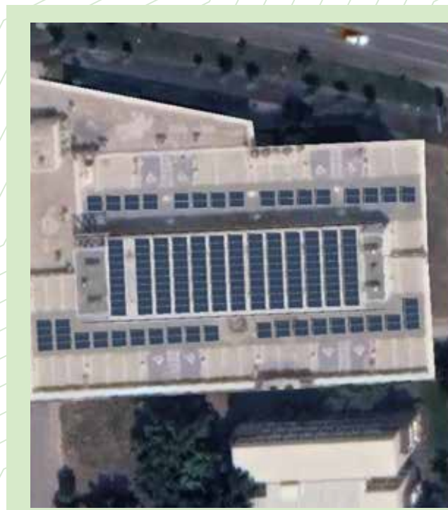
Слика 22. Визуелен приказ на предвидениот фотоволтаичен систем на кровната површина на катна гаража Судска Палата
