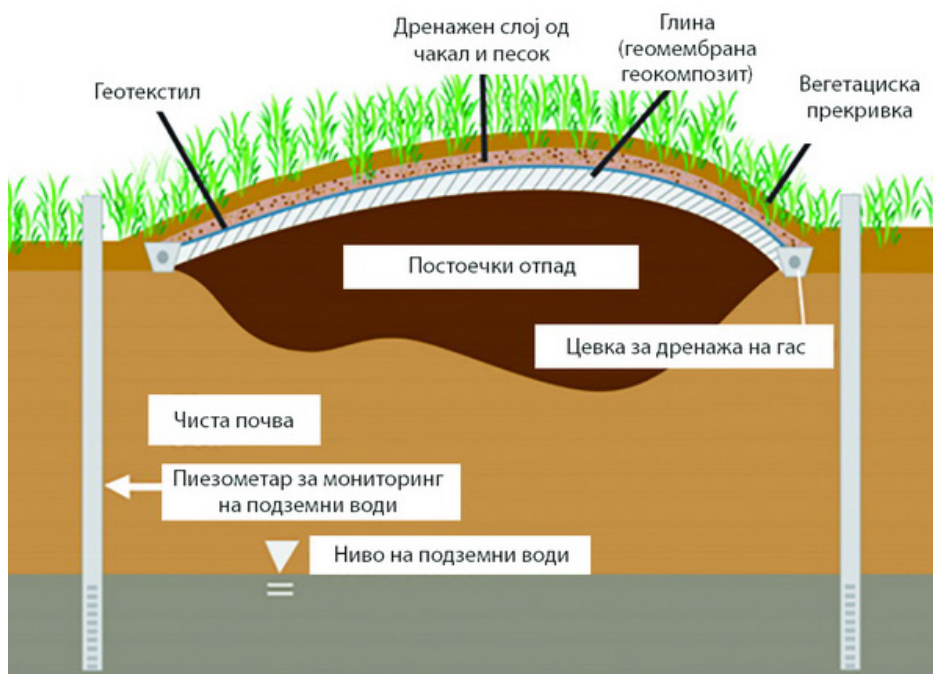
Слика 1 - Шематски приказ на затворање депонија
