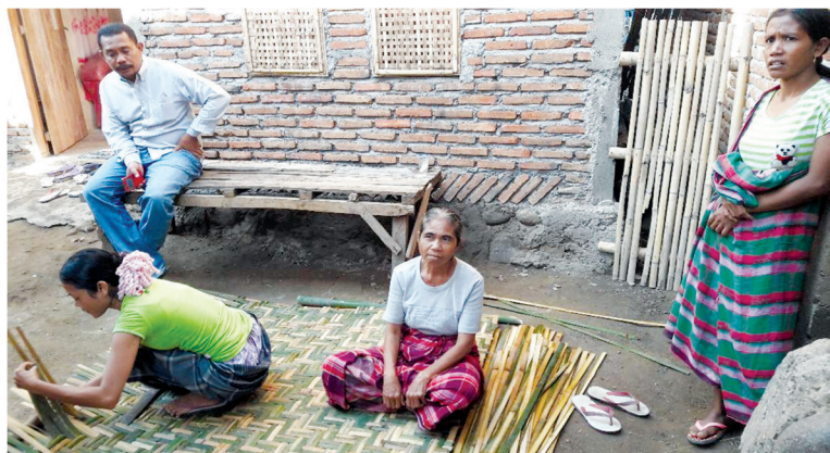
Gambar 4.11 Pembuatan “Bedek” – Anyaman Bambu Untuk Dinding Rumah
