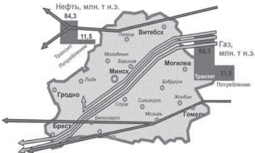
**Рис. 8.** Схема топливных потоков газа и нефти в Беларусь и показатели транзита и потребления топлива в 1998 г. (соответственно: газ млн. т н.э. 29,0 и 13,0; нефть, млн. т н.э. 84,3 и 11,5)
