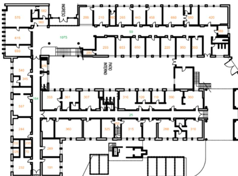
Figura 4: Promedios de luminancia sobre el plano de trabajo por área individual Planta Alta
