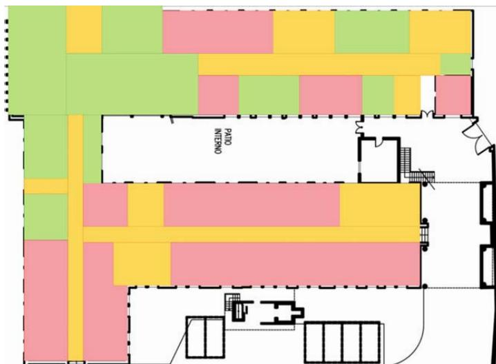
Figura 8: Representación gráfica del grado de iluminación en Planta Baja
