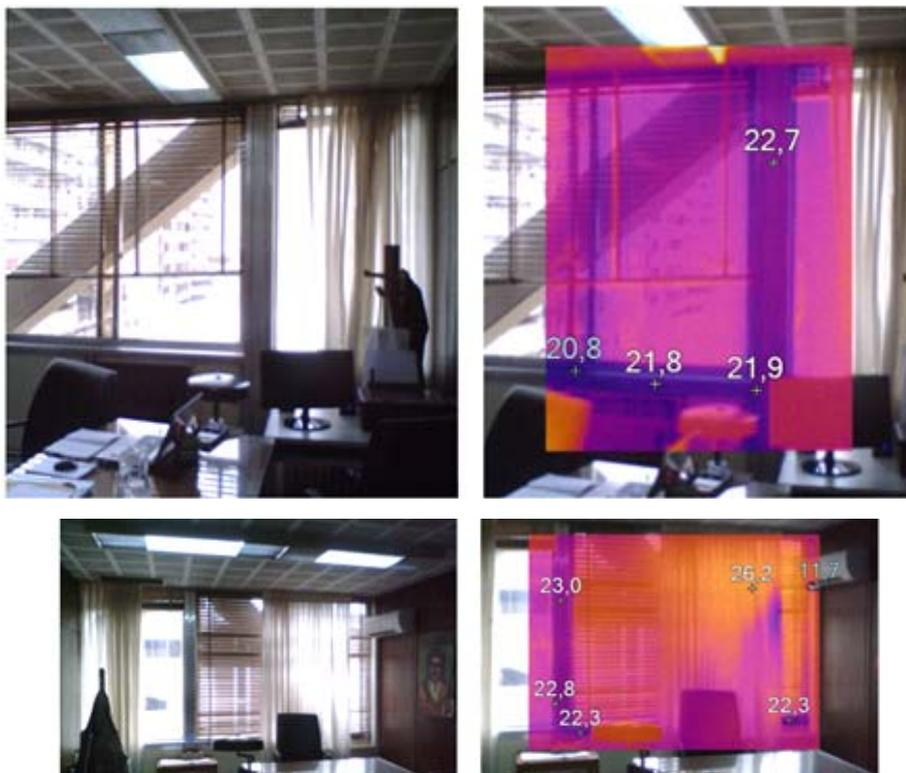
En las termografías anteriores se observa un gradiente térmico elevado en la zona de ventas debido a la radiación solar incidente que eleva la temperatura de los vidrios y al equipo de aire acondicionado que se encuentra encendido.
