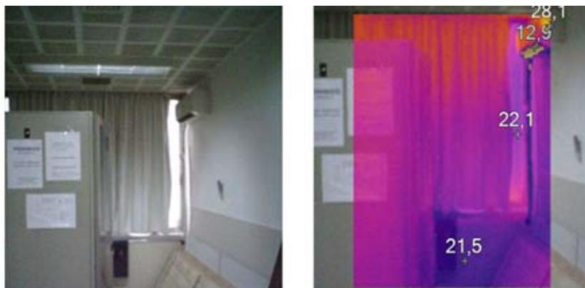
En la imagen se observa que la temperatura no es uniforme en la sala debido a la falta de aislación en los paneles de madera y ventana, produciéndose puentes térmicos que incrementan el consumo del sistema de refrigeración que se encuentra configurado a una temperatura relativamente baja.
