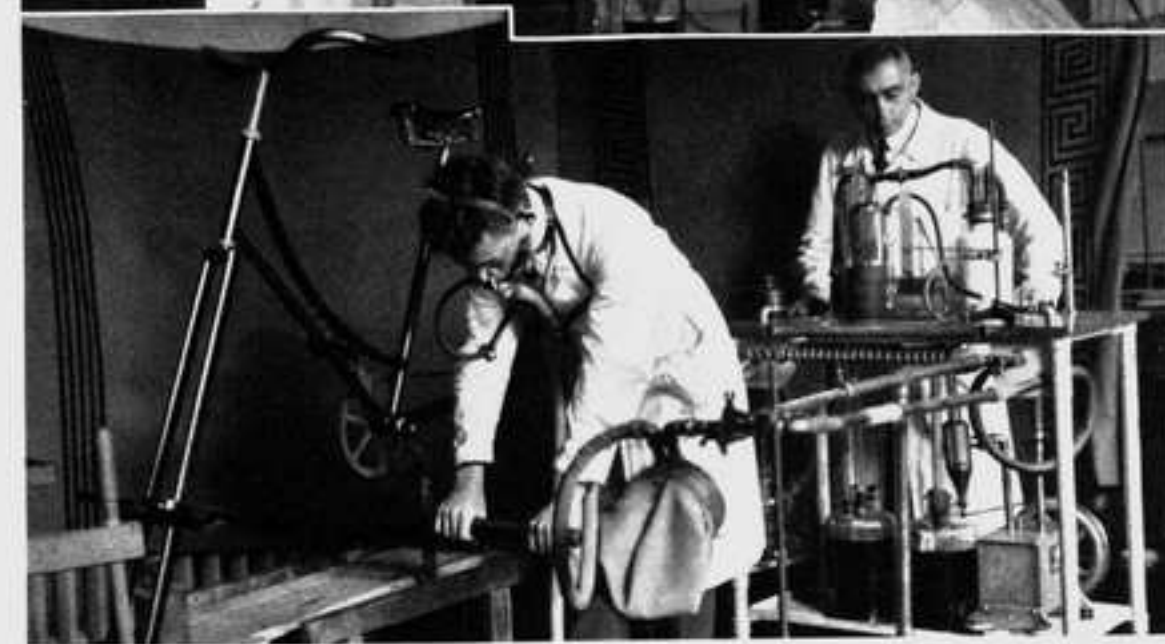
Bild 23. Der Pettenkofer'sche Respirationsapparat im Physiologischen Institut der Universität, mit dem Stoffwechseluntersuchungen bei sportlicher Arbeit vorgenommen werden. — Bild 24. Dr. Herbst untersucht seine Ausatemungsluft beim Gewichtheben. — Bild 25. Dr. Lehmann das gleiche beim Drehen einer Rolle. Am Untersuchungstisch Dr. Füll.
