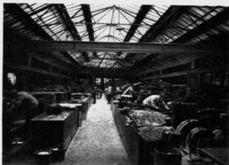
Einer der Waschsäle, in denen der Gummi gesäubert und zu Fellen gewalzt wird.
