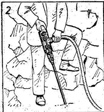
Bild 2. Bohrhämmer mit Schlauch und Bohrer. Das Ende des Schlauches kann einfach an die Preßluftleitung der Betriebsmaschine angeschlossen werden, indem die Überwurfmutter an das Ventil angeschraubt wird.
