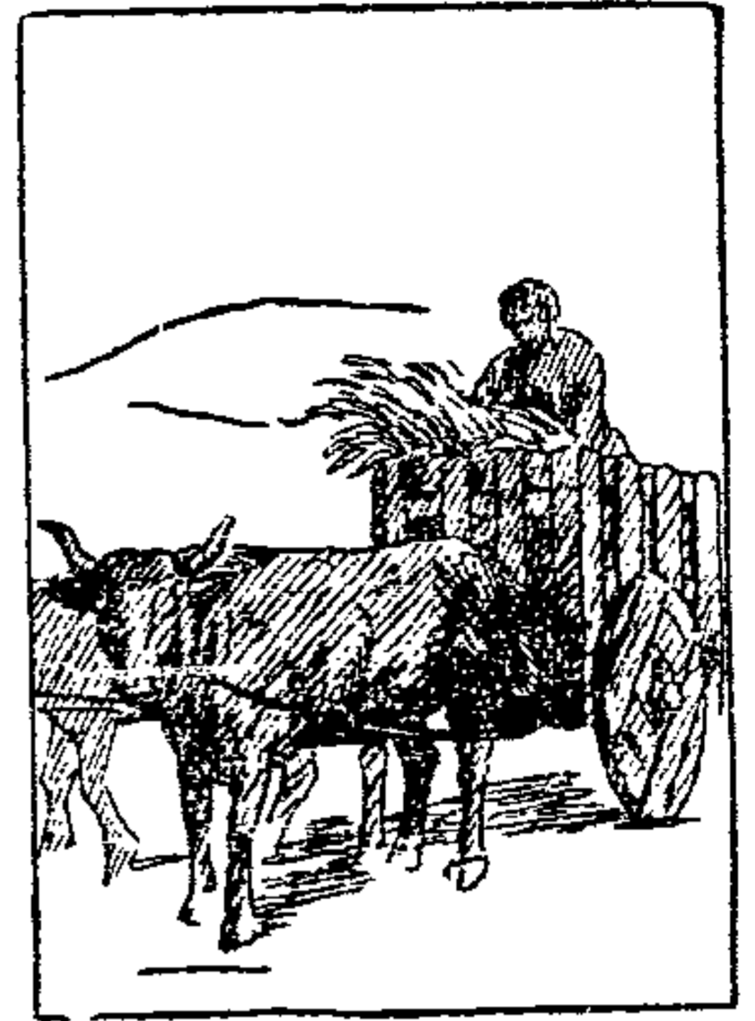
Die Urform des Wagens. Die Räder haben noch keine Speichen, sondern bestehen aus runden Scheiben.
