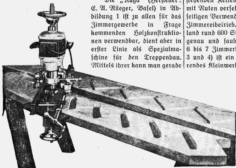
Abbildung 1. Die „Ruga“ als Treppensteinfräse.
