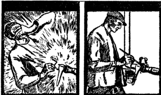
„NICHT ABLEUCHTEN!“ „SEIFENWASSER BENUTZEN!“
