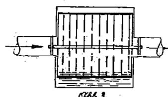
Diese fallen, dem Schwerkraft folgend, quer durch die Trommel wieder nach unten, bilden im Hohlraum einen Wassernebel und zwingen den durchströmenden Staub, sich im Wasserbad abzulagern.
