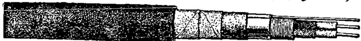
Abb. 1. Anthygron-Rohrdraht mit eingelegtem blanken Kupferleiter.
