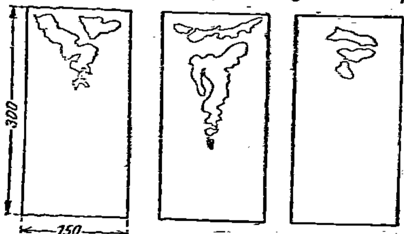
Abb. 15. Einfluß der Art des Gießens auf den Lunker.
