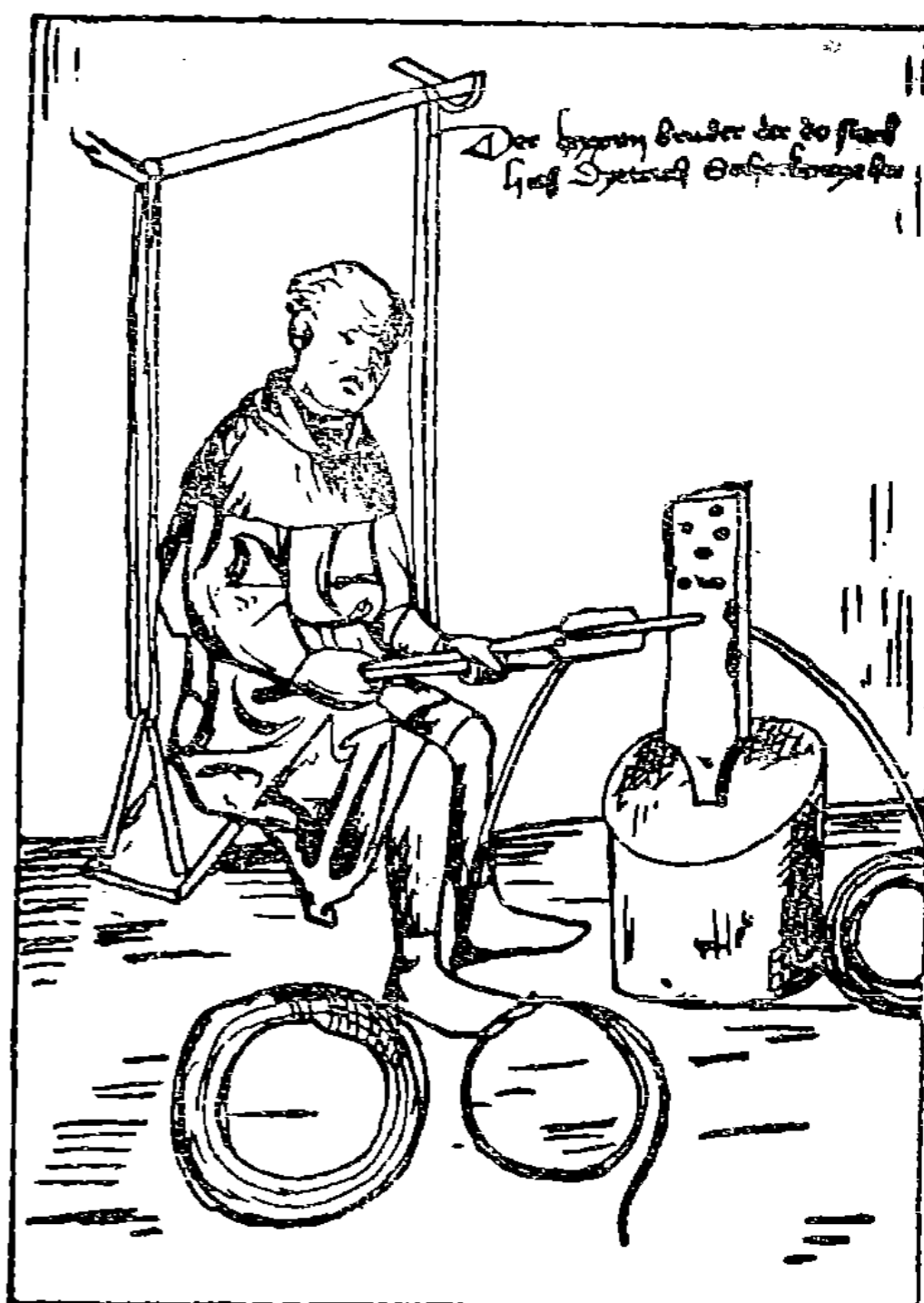
Mönch beim Drahtziehen Nach einem alten Bilde um 1490.
