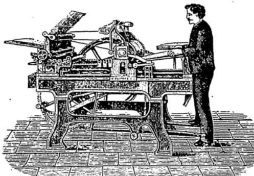
1877 in Nürnberg mit der „silbernen Votiv- tafeln“ (einzigen und höchstem Preis der aus- gestellten Buchdruck-Schnellpressen, prä- miert, eignet sich zu Zeitungs-, Werk-, Bunt- und Accidenzdruck gleich gut. Die e- Maschine liefert mittelst verbesserten Anle- gungsapparats genauestes Register ohne Punkturen, hat sehr leichten Gang und zur Bedienung nur eine Person nötig. Preis-Kurante, Zeichnung, Druckprobe sowie Privat-Re- ferenzen stehen franko zu Diensten.
