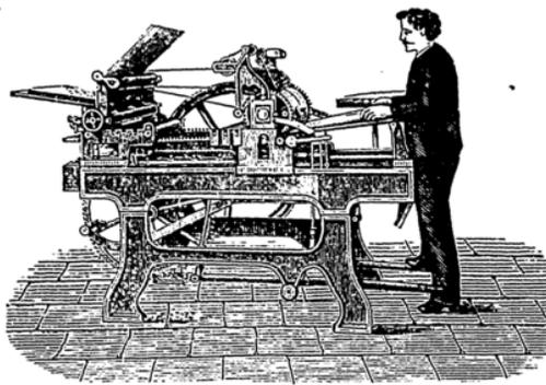
1877 in Nürnberg mit der „silbernen Votivtafel“ (einzigem und höchstem Preis der ausgestellten Buchdruck-Schnellpressen) prämiert, eignet sich zu Zeitungs-, Werk-, Bunt- und Accidenzdruck gleich gut. Diese Maschine liefert mittelst verbesserten Anlege-Apparats genauestes Register ohne Punktieren, hat sehr leichten Gang und zur Bedienung nur eine Person nötig. Preis-Kurante, Zeichnung, Druckprobe sowie Prima-Referenzen stehen franko zu Diensten.
