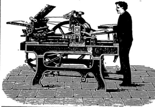
1877 in Nürnberg mit der „silbernen Votivtafel“ (einzigen und höchstem Preis der ausgestellten Buchdruck-Schnellpressen) prämiert, eignet sich zu Zeitungs-, Werk-, Bunt- und Accidenzdruck gleich gut. Diese Maschine liefert mittelst verbesserten Anlege-Apparats genauestes Register ohne Punkturen, hat sehr leichten Gang und zur Bedienung nur eine Person nötig. Preis-Kurante, Zeichnung, Druckprobe sowie Prima-Referenzen stehen franko zu Diensten.
