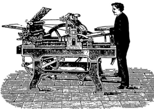
1877 in Nürnberg mit der „silbernen Votivtafel“ (einzigem und höchstem Preis der ausgestellten Buchdruck-Schnellpressen) prämiert, eignet sich zu Zeitungs-, Werk-, Bunt- und Accidenzdruck gleich gut. Diese Maschine liefert mittelst verbesserten Anlege-Apparats genauestes Register ohne Punkturen, hat sehr leichten Gang und zur Bedienung nur eine Person nötig. Preis-Kurante, Zeichnung, Druckprobe sowie Prima-Referenzen stehen franko zu Diensten.
