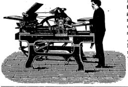
tafel" (einzigem und höchstem Preis der ausgestellten Buchdruck - Schnellpressen) prämiiert, eignet sich zu Zeitungs-, Werk-, Buntund Accidenzdruck gleich gut. Diese Maschine liefert mittelst verbesserten Anlege-Apparats genauestes Register ohne Punkturen, hat sehr leichten Gang und zur Bedienung nur eine Person nötig. Preis-Kurante, Zeichnung, Druckprobe sowie Prima-Referenzen stehen franko zu Diensten.
