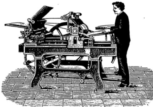
1877 in Nürnberg mit der „silbernen Votivtafel“ (einziger und höchster Preis der ausgestellten Buchdruck-Schnellpressen) prämiert, eignet sich zu Zeitungs-, Werk-, Bunt- und Accidenzdruck gleich gut. Diese Maschine liefert mittelst verbesserten Anlege-Apparats genauestes Register ohne Punkturen, hat sehr leichten Gang und zur Bedienung nur eine Person nötig. Preis-Kurante, Zeichnung, Druckprobe sowie Prima-Referenzen stehen franco zu Diensten.
