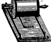
Der mit Filz überzogene Cylinder wird einfach über die geschwärzte mit dem Papier belegte Schrift gerollt und giebt die saubersten Abzüge. Die Schienen, auf welchen die Walze läuft, sind der Schrifthöhe angemessen stellbar. Man kann, mit genau justirten Schiften, deren Bodenstärke gleich ist, auch in den Schiften selbst abziehen.
