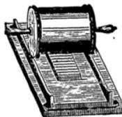
Der mit Filz überzogene Cylinder wird einfach über die geschwärzte mit dem Papier belegte Schrift gerollt und giebt die saubersten Abzüge. Die Schienen, auf welchen die Walze läuft, sind der Schrifthöhe angemessen stellbar. Man kann, mit genau justirten Schiffen, deren Bodenstärke gleich ist, auch in den Schiffen selbst abziehen.
