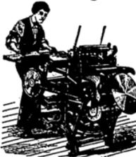
Degener & Weller's Original, einfachste, beste und leistungsfähigste Presse für Accidenzdruck. Ihre Vorzüge vor anderen Tiegeldruck- Maschinen bestehen hauptsächlich in dem wagerechten Liegen, deshalb zur Revision und Reinigung der Form jederzeit zugänglichen Fundament, während diese Arbeiten bei den meist senkrecht liegenden Fundamenten anderer Tiegeldruck-Maschinen nur nach erfolgtem Aushoben vorzunehmen sind; ferner in einem neu construirten vorzüglichen Farnenwerk.
