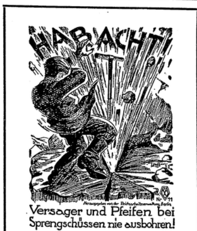
Versager und Pfeifen bei Sprengschüssen nie ausbohren!
