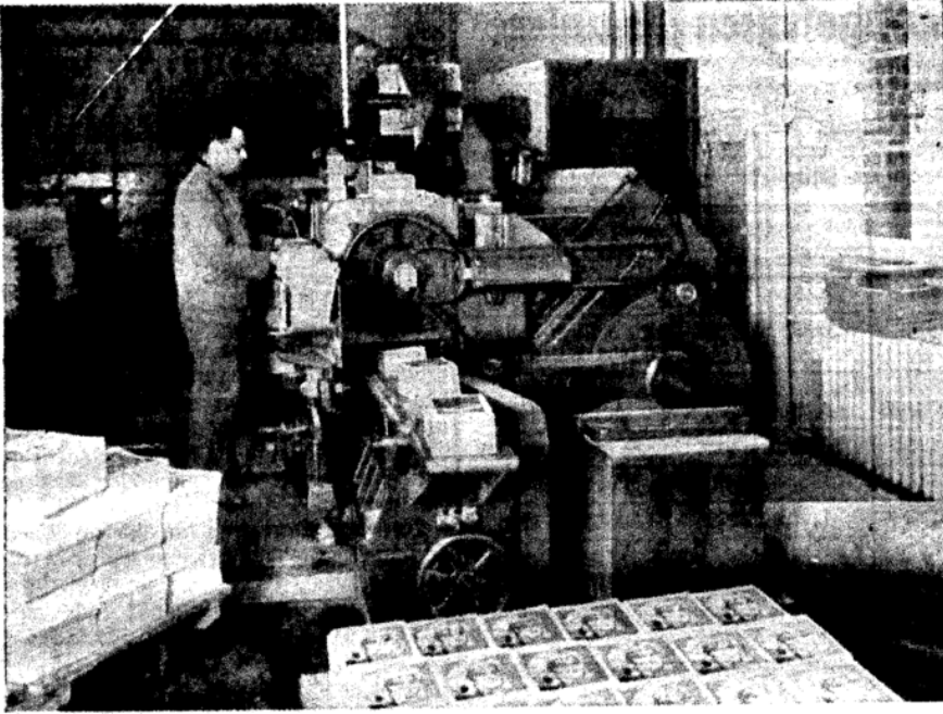
2. Seybold-Schneidemaschine zum Beschneiden von Broschüren im Ullstein-Druckhaus, Berlin-Tempelhof. (Die Späne werden durch das Rohr rechts abgelaugt und fallen in den Keller. Stundenleistung 8000 bis 10 000 Exemplare des „Uhu“.) Phot. Kraszewski.
