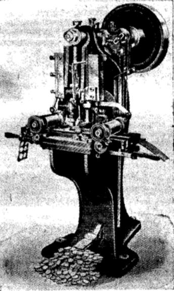
maschine überlassen. Eine erhöhte Leistung der Einzelstanzung auf einer Tiegeldruckpresse kann aber dadurch erzielt werden, daß man der Arbeitsfläche entsprechend mit mehreren Stanzwerkzeugen nebeneinander arbeitet.
