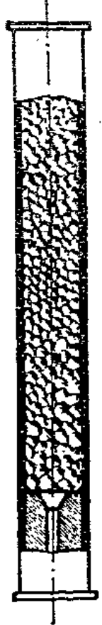
Heizrohr für Dampfheizsystem mit flammenloser Feuerung
